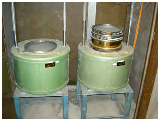
Bild 6. 0-8 mm delades på 2 mm i en skak-sikt. 2-8 mm tillfördes sedan delen 8-22,4 mm.
