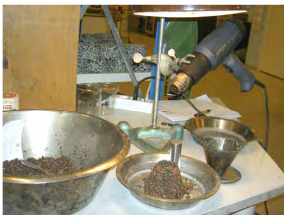
Bild 15. Utrustning för att åstadkomma yttorr tillstånd hos material mindre än 4 mm.
