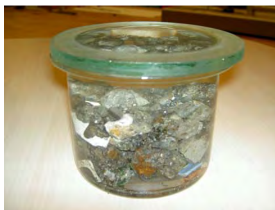
Bild 16. Densiteterna bestämdes i vatten och med pycnometer.
