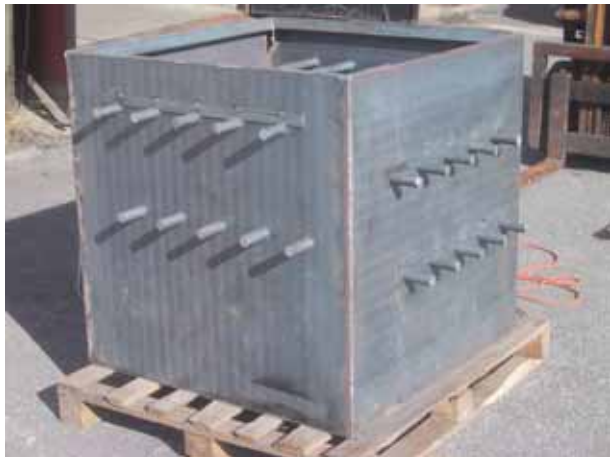
Bild 9. Statisk blandare för sammansatta SLAGG-produkter.
