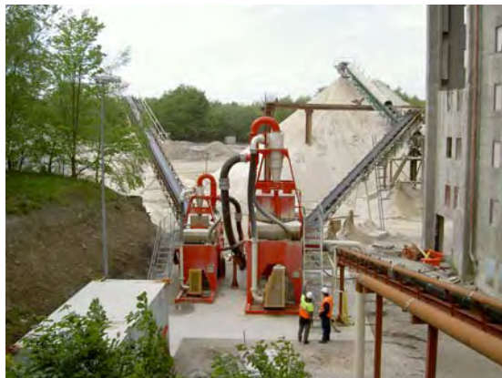
Bild 2. Eftertvätt som tar bort material mindre än 0,1 mm.
