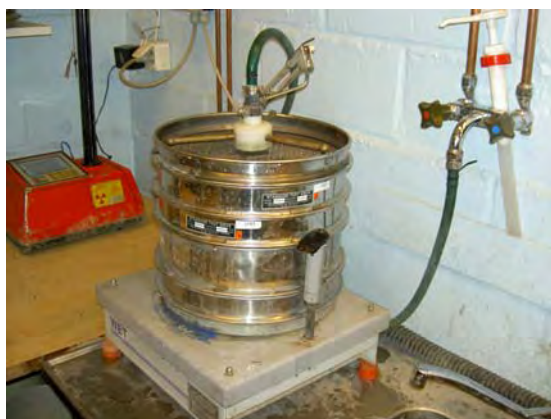
Bild 8. Vatten sprinklades över slaggruset på siktar under vibrering.
