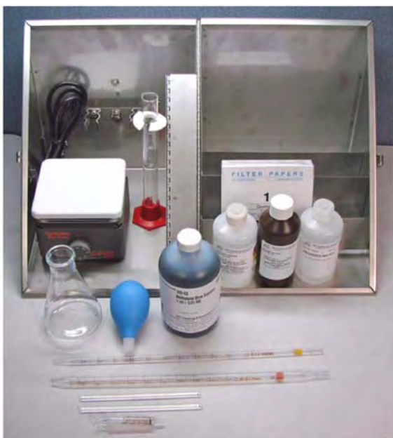
Bild 17. Utrustning för bestämning av metylenblåvärde, MB.
