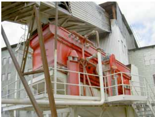
Bild 5. Tvättning är en beprövad och storskalig teknik för borttagning av findelen ur grusmaterial.
