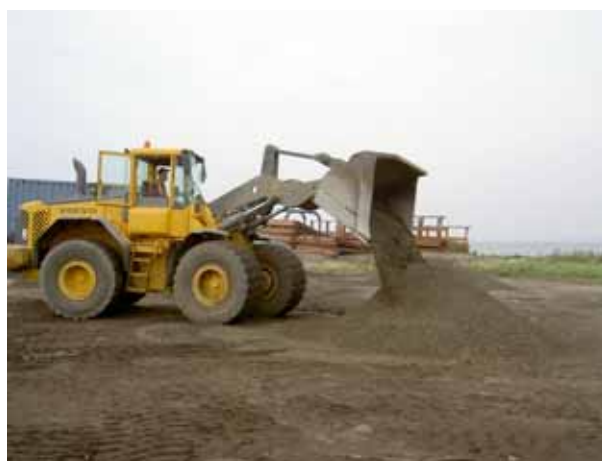
Bild 8. En lastmaskin med vägning är en enkel och säker blandning för små volymer.
