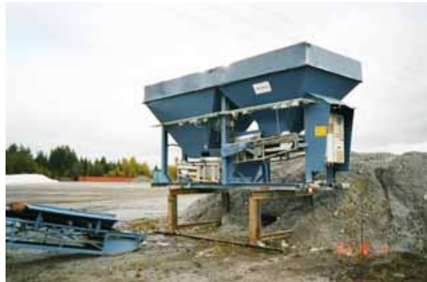
Bild 10. Mobil doseringsutrustning för sammansättning av komponenter.
