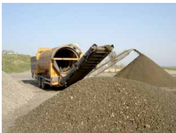
Bild 7. En trumsikt är en lätthanterlig och effektiv utrustning för uppdelning i kornstorlekar.
