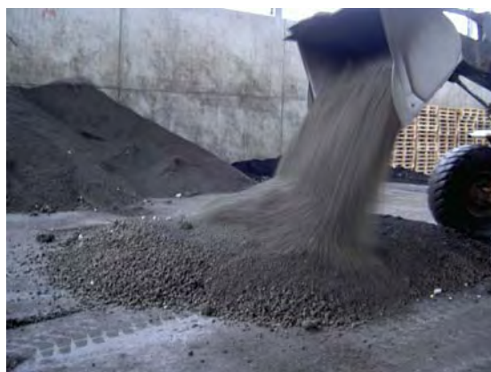
Bild 4. Blandningen gjordes med lastmaskin med vägning i en hall för beredning av bränslen
