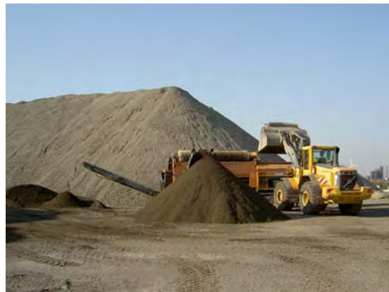
Bild 4. Material större än ca 10 mm togs bort genom trumsiktning.
