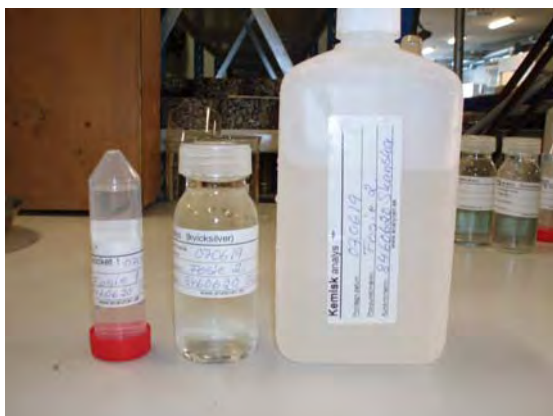
Bild 13. Från vänster: behållare för vattenanalys av Hg, i mitten för övriga metaller och till höger pH, konduktivitet och salter ur samma prov.
