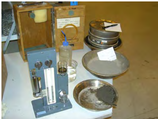
Bild 20. Utrustning typ M/50 för bestämning av kapillaritet.
