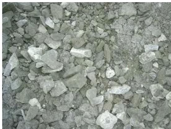
Bild 4. Materialet bestod av sammansatt krossmaterial av berg och asfalt.
