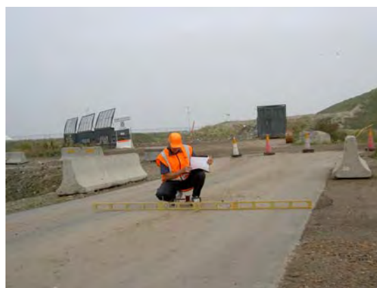
Bild 26. Spårdjupet mättes med en rätskiva.
