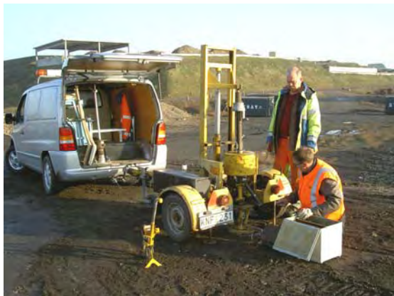
Bild 21. Med tung fallvikt bedömdes bärförmågan hos underlaget.
