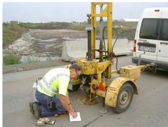
Bild 24. Fallviktsmätning efter 8 månaders tung trafik i augusti 2007.
