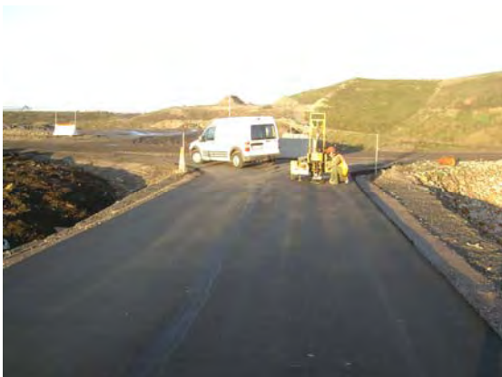
Bild 23. Fallviktsmätning en kylslagen decem-berdag 2006 på nylagd asfalt.
