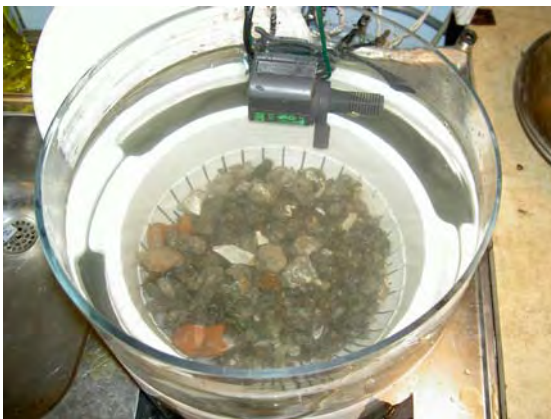
Bild 11. Lakförsök enligt SS-EN 1744-3 med tvättat SLAGGgrus 2-22,4.
