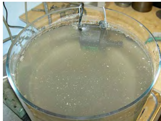
Bild 12. Findelen i SLAGGsand 0-2 grumlar lakvattnet.
