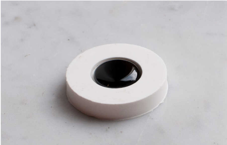
Figur 22 Färdig provkropp för 25mm i form
