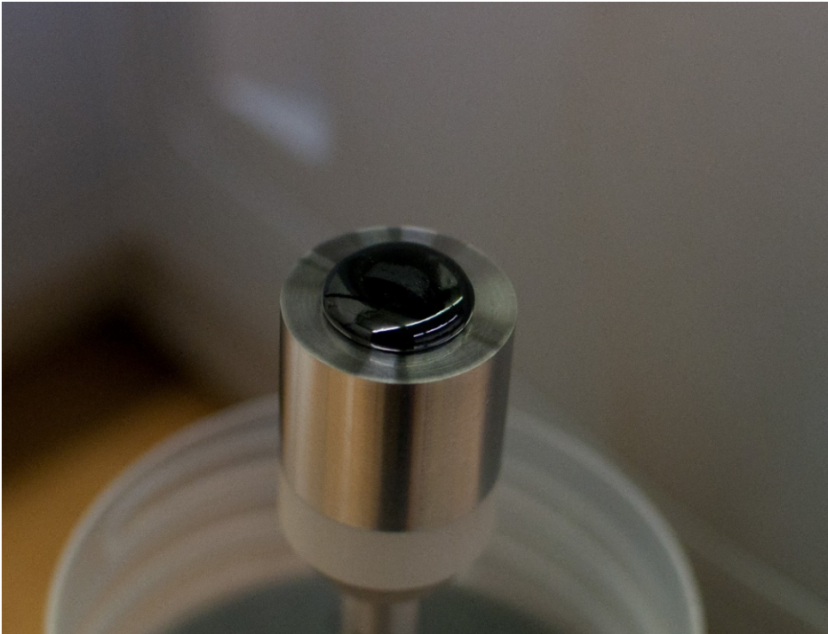
Figur 23 Provkropp applicerad på PP25 mät huvud
