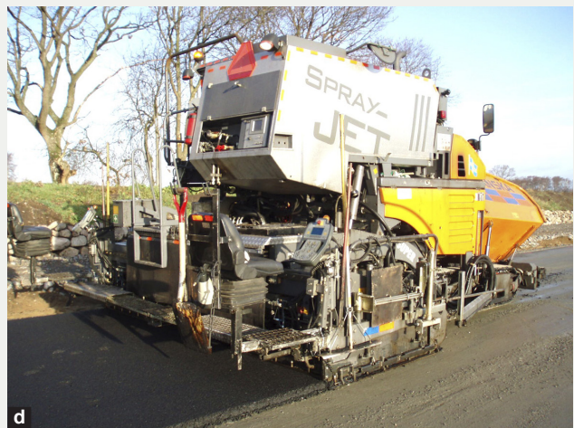
Massaprover innehållande returafalt med och utan förnyngsmedel respektive helt nyttillverkad asfalt togs ut efter inlastningsfickan (a.), efter parallelltrumman (b.), efter utlastning av färdigblandad asfalt (c.) och slutligen i asfaltläggarens breddökning ute på vägen (d.).
