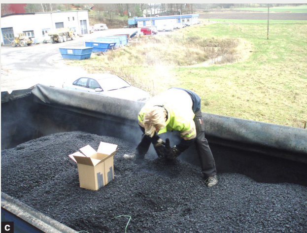
Massaprover innehållande returafalt med och utan förnyngsmedel respektive helt nyttillverkad asfalt togs ut efter inlastningsfickan (a.), efter parallelltrumman (b.), efter utlastning av färdigblandad asfalt (c.) och slutligen i asfaltläggarens breddökning ute på vägen (d.).
