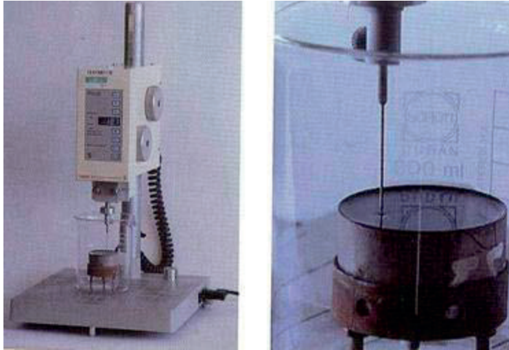
Figur 2-12: Visar en testapparat för penetrationstal (Read & Whiteoak, 2003)
