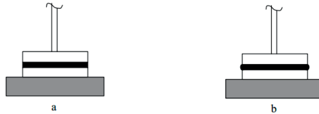
Figur 3-9: Provkropp efter trimning (a) samt efter sänkning till mäthöjd (Nordtest, 2002)
