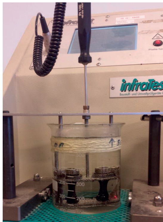
Figur 2-13: Mjukpunktstest med Kula & Ringmetoden
