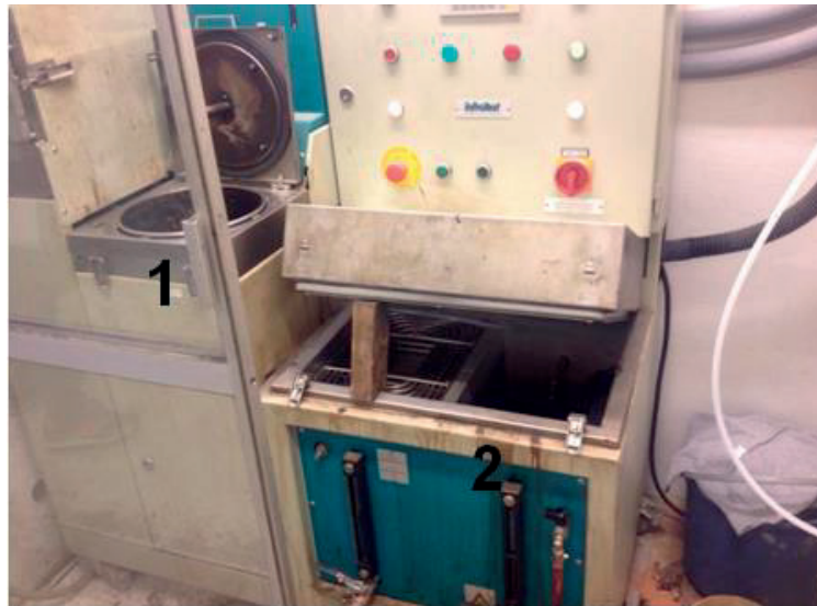
Figur 3-2: Separering av filler vid 1 och uttagning av återvunnet bitumen samt diklormetan vid 2
