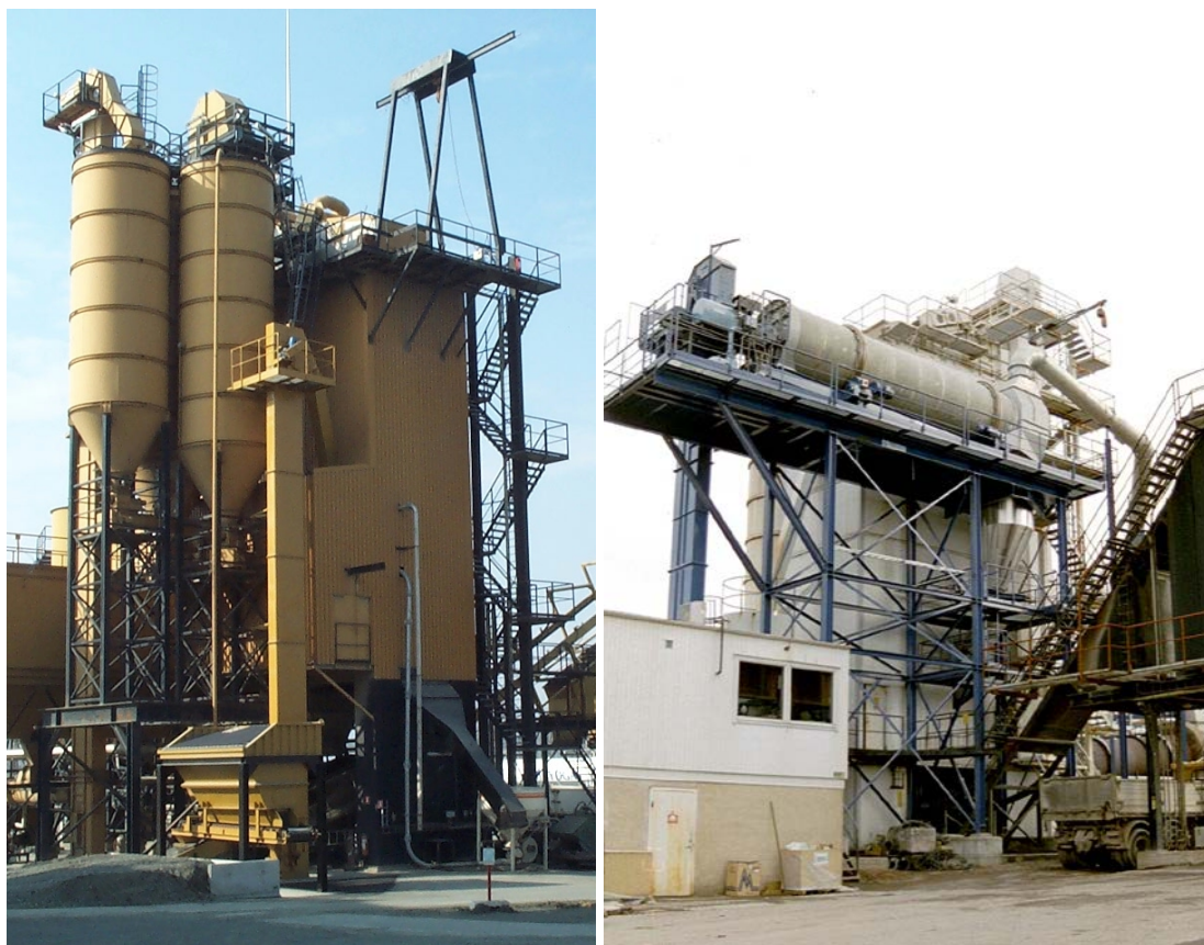
Bild 3-7 Kalldosering (t.v.) och uppvärmning av returafalt med parallelltrumma.
