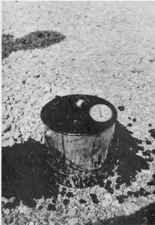
BILD 1. Temperaturmätning (här i samma hink som ska undersökas).
