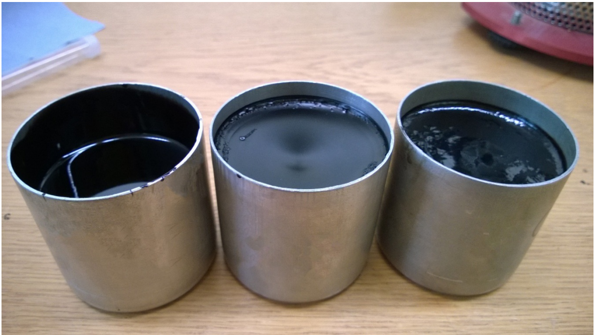
Figur 7. Penetrationsburkar med bitumen, fr v 70/100, Sas 85-3 och PMB
