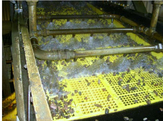
Bild 2-10 Högtryckstvätt över plastsiktar är bara en av teknikerna. Uppdelning på flera linjer ger anläggningen hög kapacitet.
