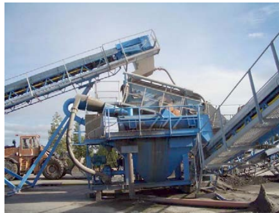
Bild 2-18 Slammet skiljs från sanden i en tvättcyklon. Bild: NCC Roads
