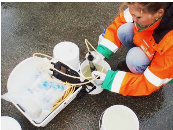
Bild 4-1 Mätning av konduktivitet och pH i tvättvatten.
