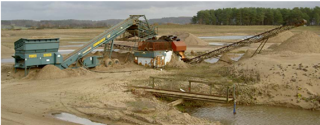
Bild 2-4 Tvättning av sand till lekplatser och plattsättning hos Skåne Grus i Ilstorp.
