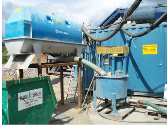
Bild 3-8 Finslamman 0-0,2 mm passerar avskiljaren för lätt, organiskt material innan den går vidare.
