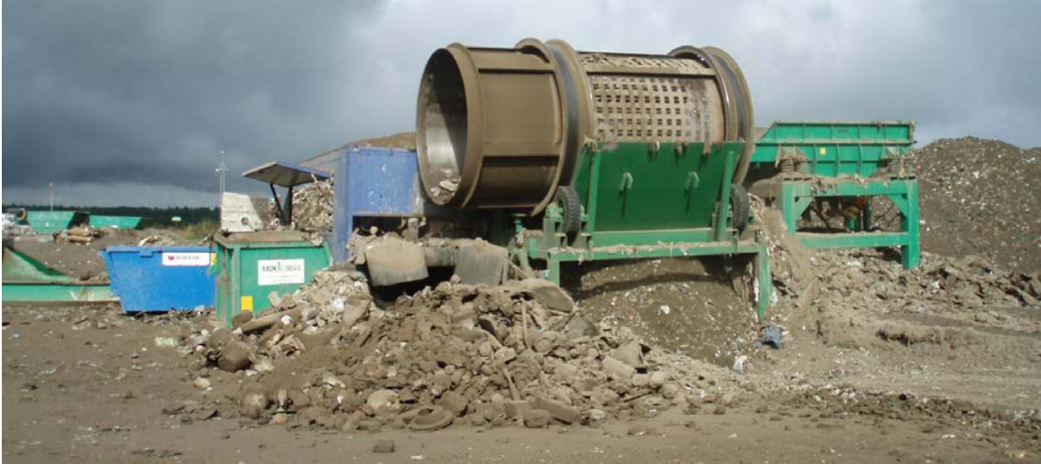
Bild 4-8 Förbehandling av slaggrus från Högdalen på Ragn-Sells deponi i Högbytorp.
