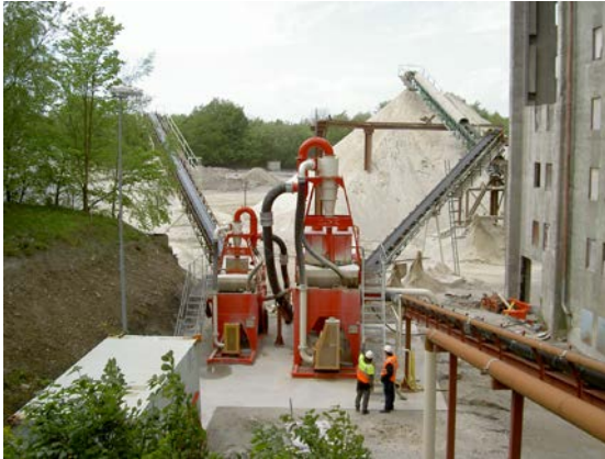
Bild 2-2 I eftertvätten avskiljs material mindre än 0,1 mm i form av slam.
