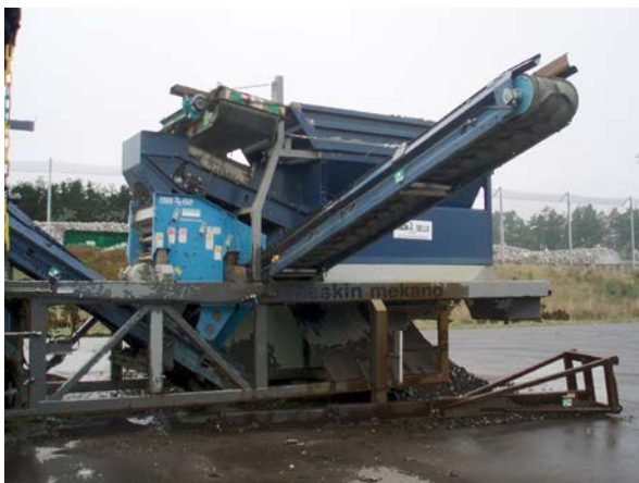
Bild 3-3 Utmatning av grova föroreningar och järn.
