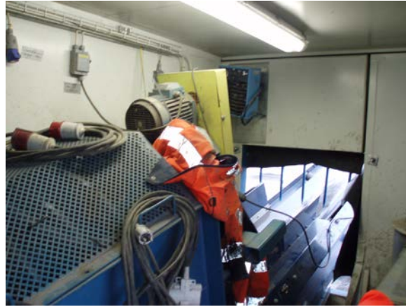
Bild 3-6 Skruvklasseraren vaskar fram 0,2-2 mm, som matas ut ur containern.
