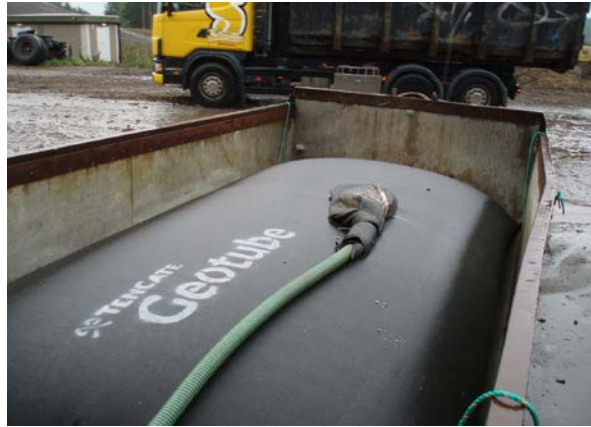
Bild 3-12 Om Geotuben placeras i en tät container kan vattnet återföras till tvättprocessen.
