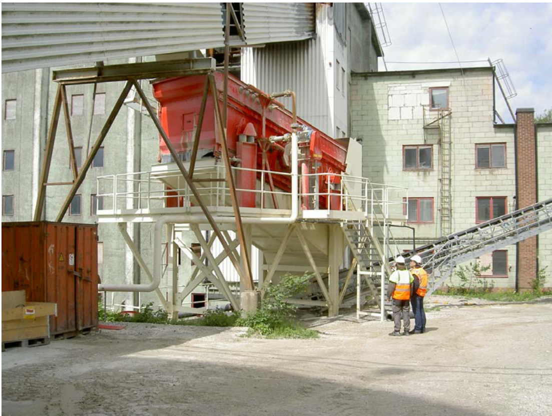
Bild 2-1 Förtvätten i Hardeberga avskiljer material mindre än 2 mm från inmatat 0-16-material. Sandslamman går sedan vidare till eftertvätten.
