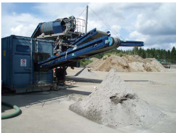
Bild 4-3 På Linneberga återvinningsstation i Småland provtvättades slaggrus som körts dit från Högbytorp.
