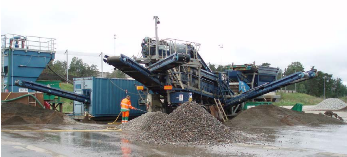
Bild 3-1 Ragn-Sells tvättanläggning från utmatningssidan med färdigtvättat material.
