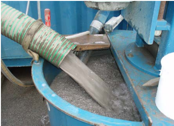
Bild 3-9 Slamman tillförs flockningsmedel för att finmaterialet ska sedimentera snabbare.
