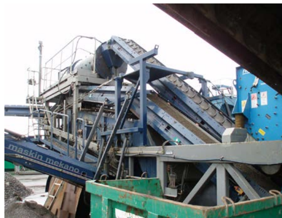
Bild 3-4 Ett övre band matar grus >8/16 mm till trumtvätten medan ett undre matar <8/16 direkt till underliggande siktdäck med högtrycksspolande dysor.
