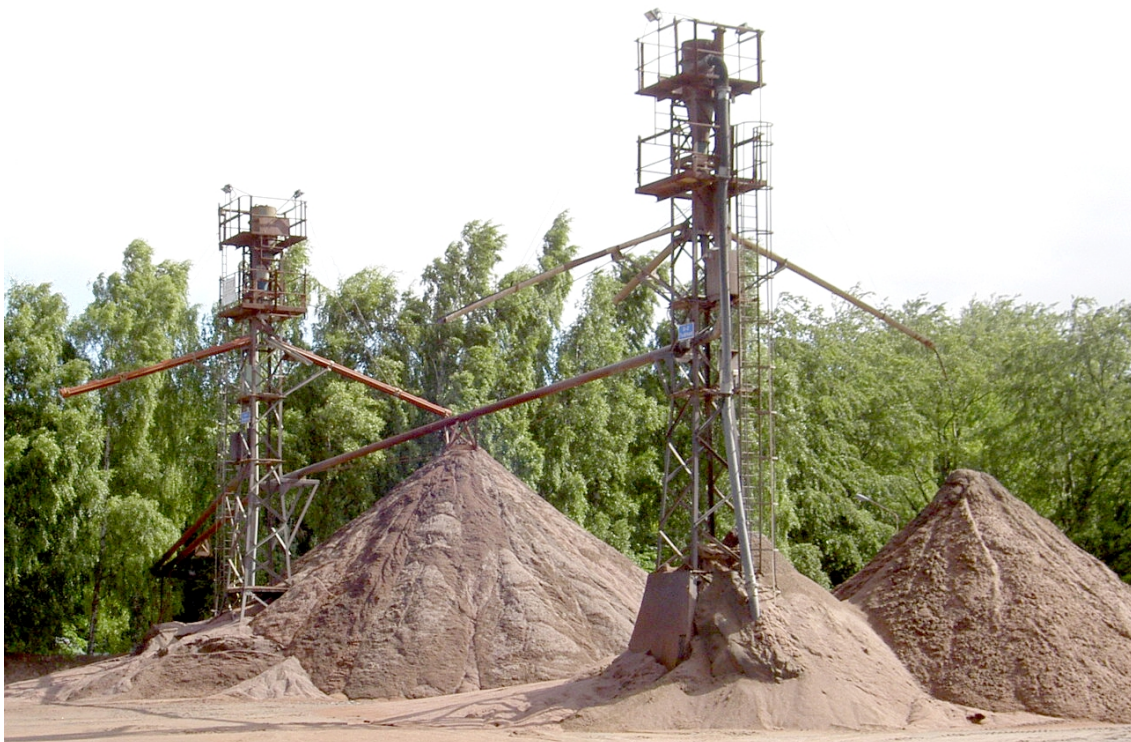
Bild 2-13 Cyclontvättning av sand hos Sydsten i Dalby. Tekniken är enkel och vanligt förekommande för att skilja silt i form av slam från sand.
