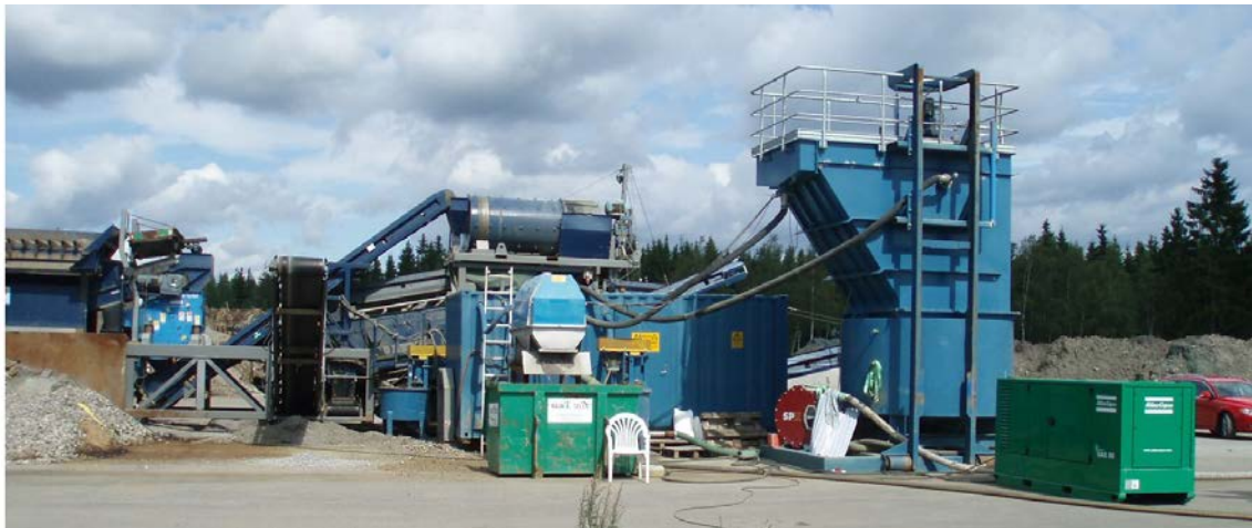
Bild 3-2 Slamavskiljning i en lamellförtjockare från inmatningssidan.
