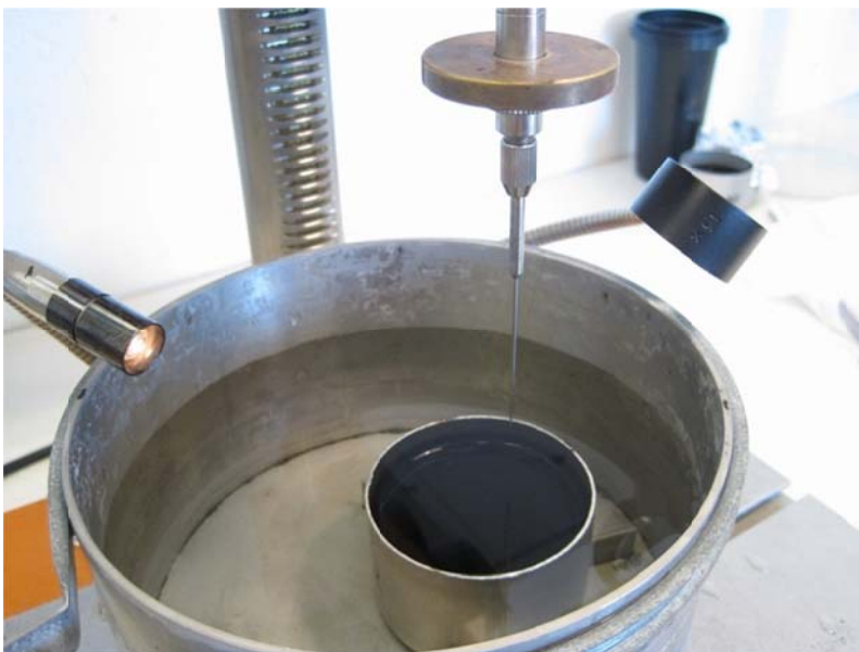
Figur 3-4: Provkopp med bitumen placerad i vattenfylld behållare (25°C) och nål
