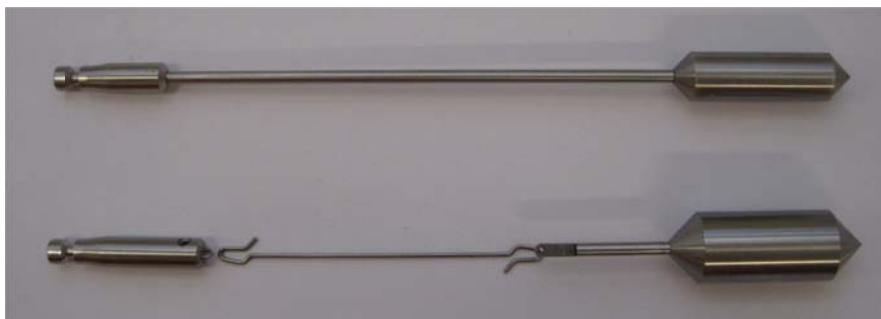
Figur 3-2: Spindel SC4-27 (över) och spindel SC4-21 (under)
