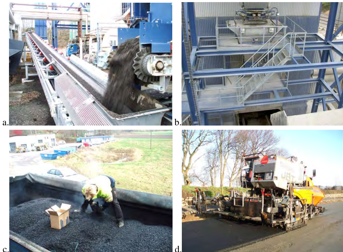
Bild 3-15 Provtagningsställen: RA/FRA efter inlastningsfickan (a.), efter parallelltrumman genom inspektionsluckan i vågen före blandaren (b.), efter utlastning (c.) och slutligen i asfalthäggarens breddökning ute på vägen (d.).
