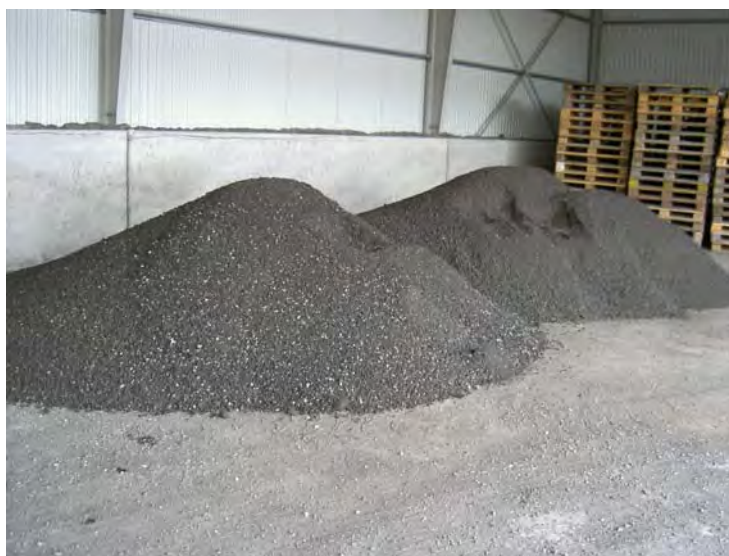
Bild 3-7 34 ton RA blandades med Nytex 820 och förvarades under tak för kontroll av sammanbaking och läckage och i avvaktan på kommande blandningsförsök.
