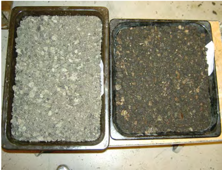
Bild 3-8 RA till vänster, FRA till höger. Nytex 820 har börjat lösa upp ljusabsorberande bitumen, därav den stora ljusskillnaden som inte riktigt motsvarades av det okulära intrycket.
