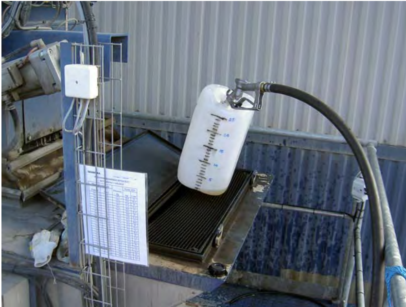
Bild 3-10 Nytex 820 hälldes genom inspektionsluckan till vågfickan före blandaren.
