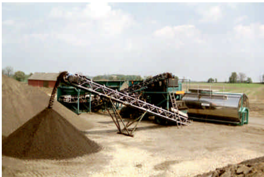
Bild 3.4-1 Skanskas kallblandningsverk med kontinuerlig blandare av typ Lucksta. Verket användes till samtliga undersökta vägbeläggningar.
