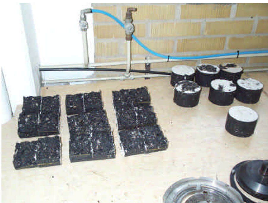
Bild 4.6-3 Gyrerade provkroppar, testade och i avvaktan på pressdragprovning.
