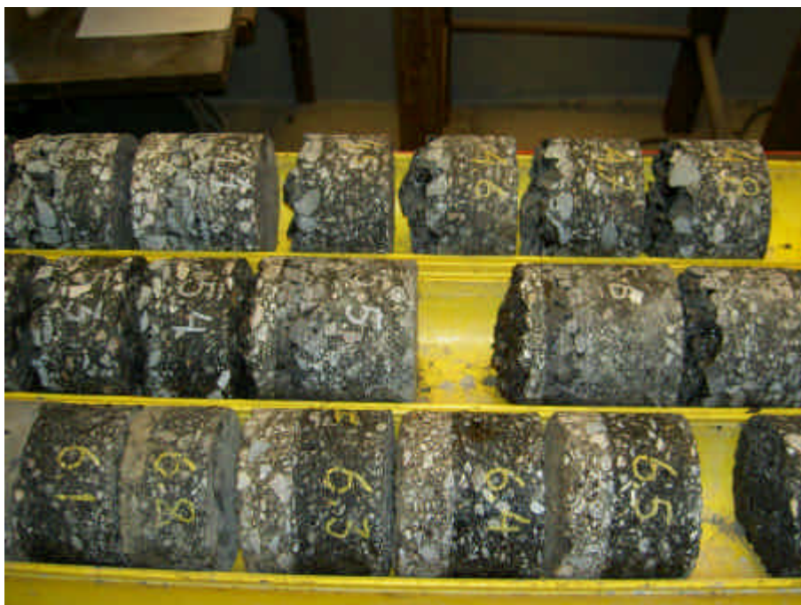
Bild 4.4-2 Borrkärnorna förvarades i plaströrshalvor innan de provades.
