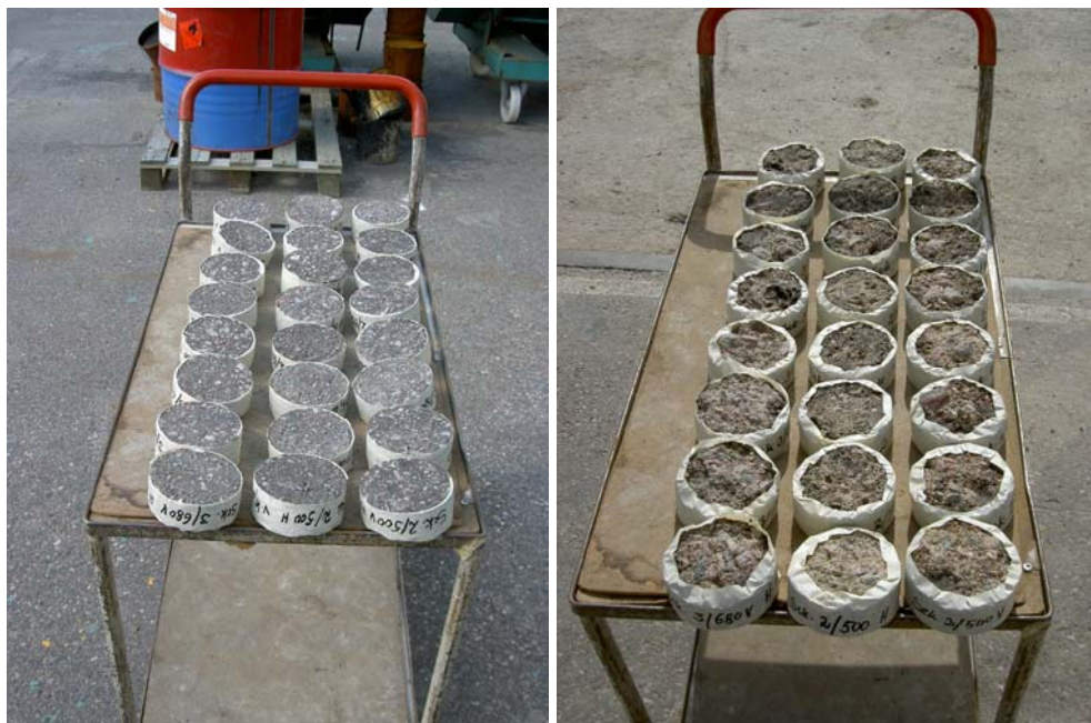
Bild 2-3: Borrhölet från ovansidan (t. v.) och undersidan med vidhängande bärlagergrus
