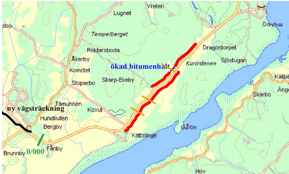
Bild 2-1: Karta över vägavsnitt med provbeläggning på väg 709. De röda linjerna markerar ungefärligt läge för MJOG med ROD och kort avsnitt med ökad bindemedelshalt.
