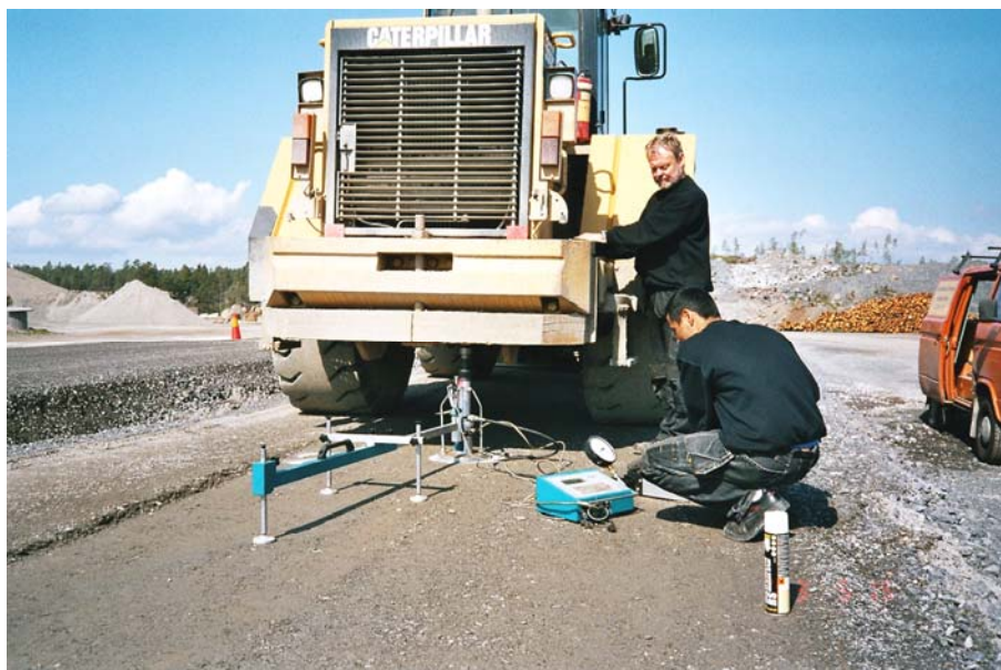
Bild B-1: Plattbelastningstest på ASFALTBär.
