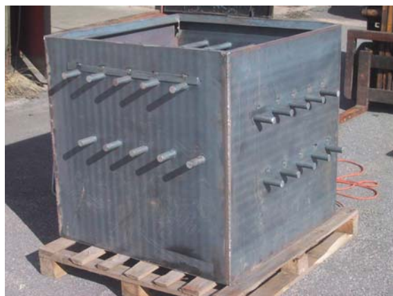
Bild 6-5: Statisk blandare och mobil doseringsutrustning för SAM-produkter.
