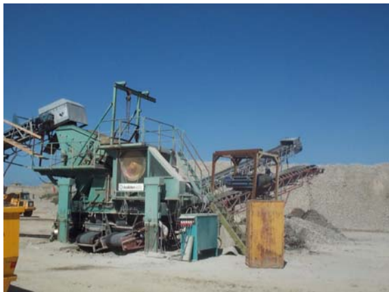
Bild 6-2: Grovkrossning av returbetong och avskiljning av metall för tillverkning av BETONGgrus på SYSAVs anläggning på Spillepeng i Malmö.
