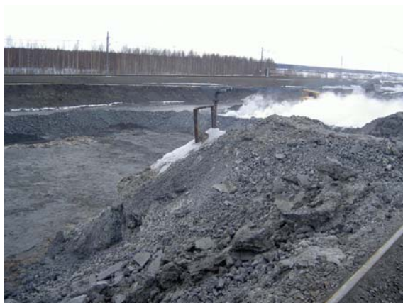
Bild 6-3: Luftkylning av masugnsslagg på SSAB i Luleå.
