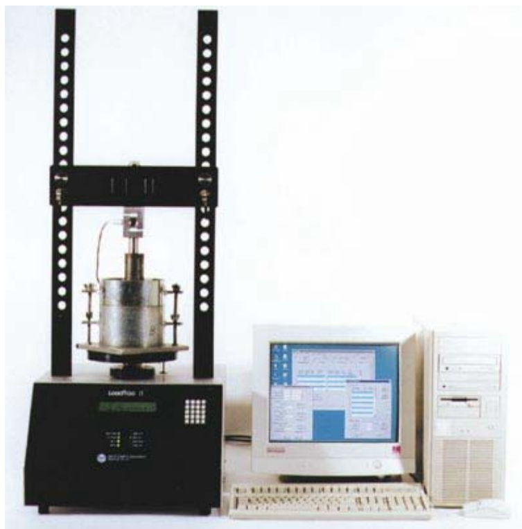
Bild B-2: CBR (California Bearing Ratio)-utrustning för stämpeltest.
