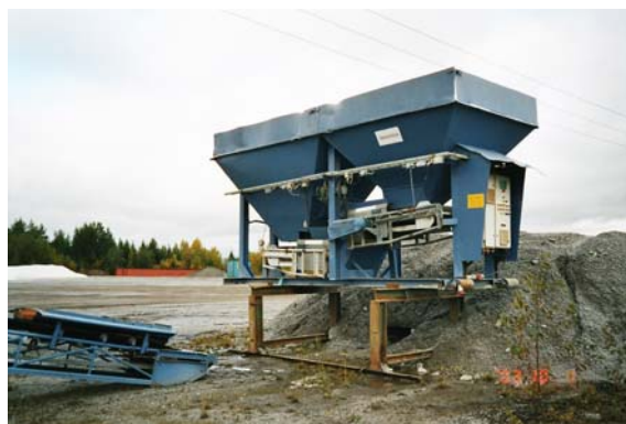
Bild 6-6: Statisk blandare och mobil doseringsutrustning för SAM-produkter
