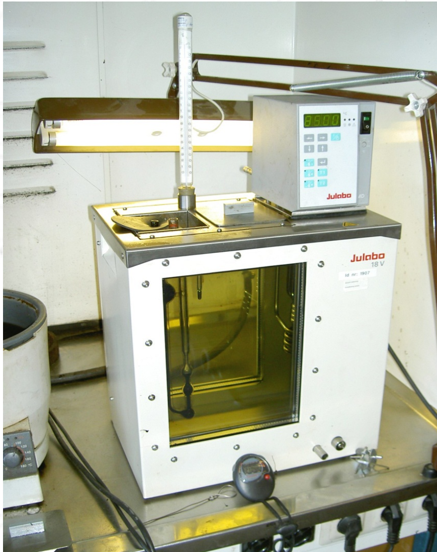
Oljebad för temperering av glaskapillärer
