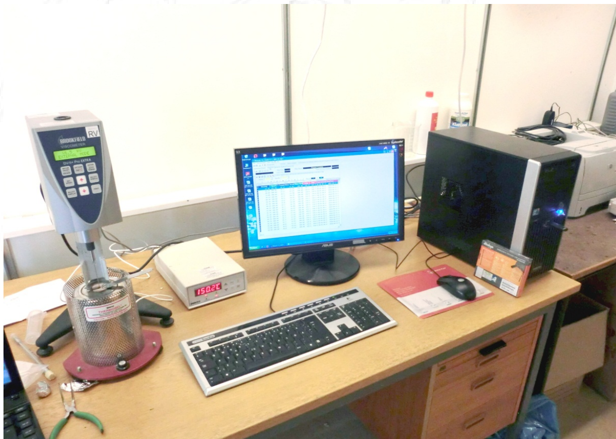
RVB-utrustningen: viskosimeter, elektrisk värmekammare och datoriserad kontroll av mätningar och insamling av resultat.
