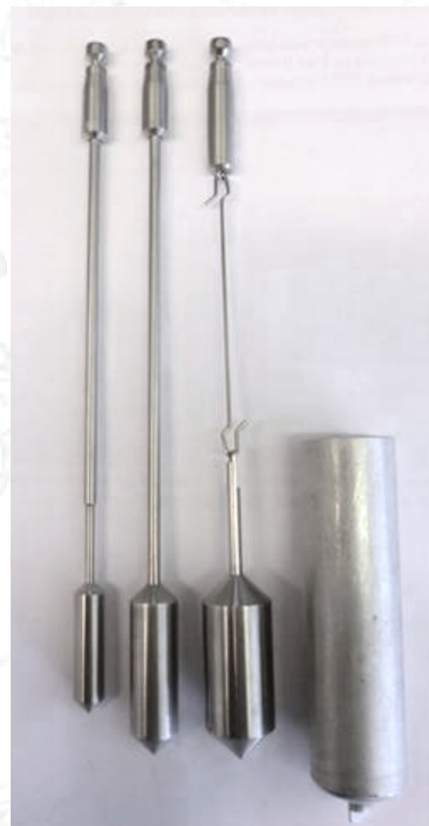
Roterande spindlar, från vänster #29, #27 och #21 och en cylindrisk provbehållare.
