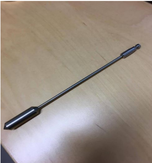
Figur 6 Spindeltyp SC4-27 som användes i maskinen
