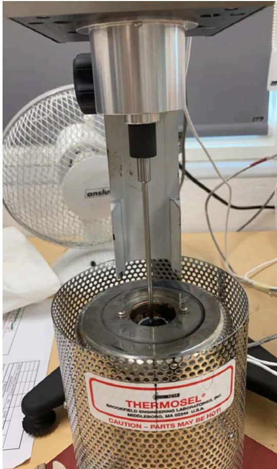
Figur 11 Spindel späns med den fasta axeln
